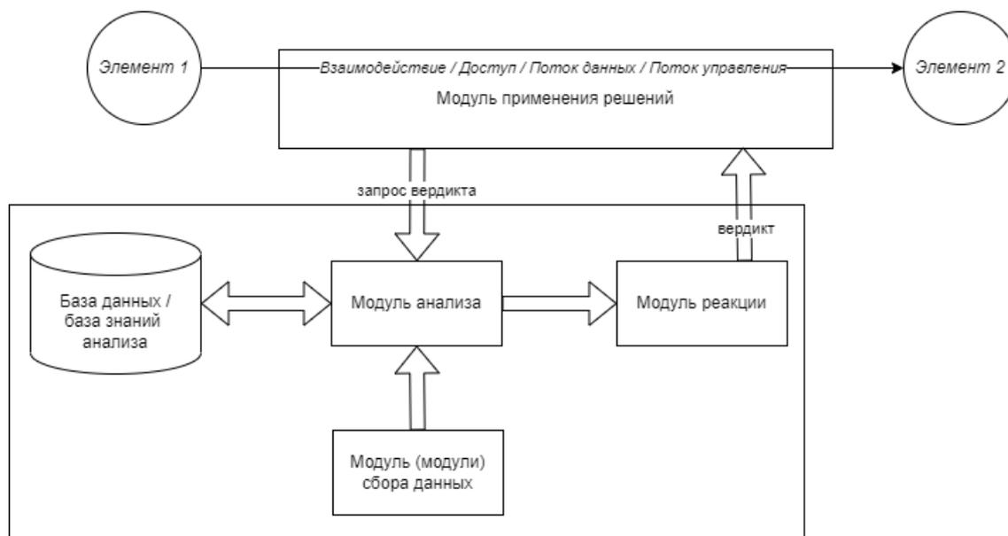
Рисунок А.2.2 – Модификация шаблона «Раздельное принятие и применение решений о безопасности» на основе шаблона «Монитор»
