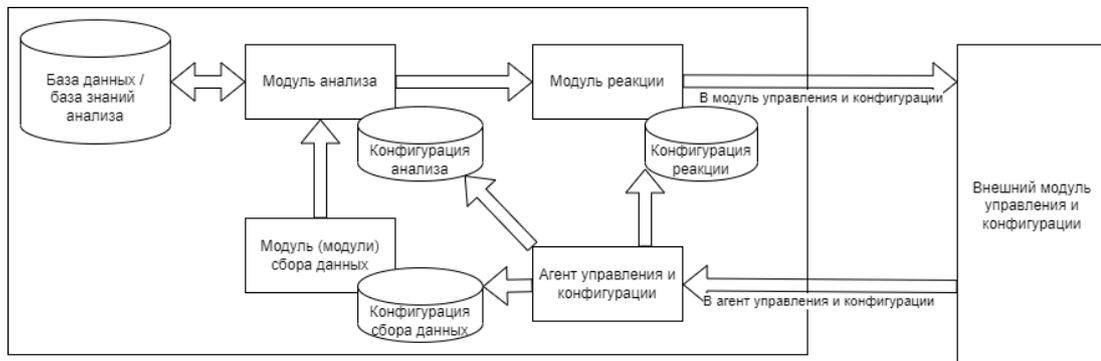
Рисунок А.1.7 – Модификация шаблона «Монитор» с обратной связью от внешней системы для управления и конфигурирования модулями шаблона
